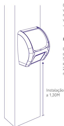
O terminal deve ser instalado em uma parede ou plataforma vertical e plana através de seus furos de fixação, localizados no gabinete traseiro. Para melhor visualização e conforto visual, a altura ideal para fixação dos verificadores de preços Jetway é de 1,30m.
