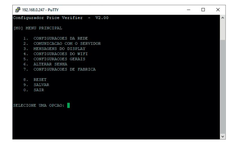
Digite 1 – Configuração de Rede. Se sua rede for DHCP os parâmetros serão automaticamente identificados conforme imagem a seguir.
