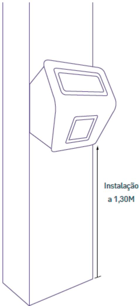
O terminal deve ser instalado em uma parede ou plataforma vertical e plana através de seus furos de fixação, localizados no gabinete traseiro. Para melhor visualização e conforto visual, a altura ideal para fixação dos verificadores de preços Jetway é de 1,30m.
