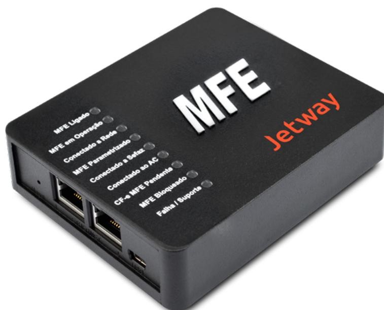
O autenticador MFE TM - 1000 foi desenvolvido especialmente para o estado do Ceará. Com legenda e LEDs em seu gabinete permite melhor entendimento dos alarmes, facilitando a manutenção e suporte no dia a dia. Além disso possibilita a emissão rápida e simplificada de cupons fiscais para todos os estabelecimentos comerciais. Fácil integração com softwares de mercado.
